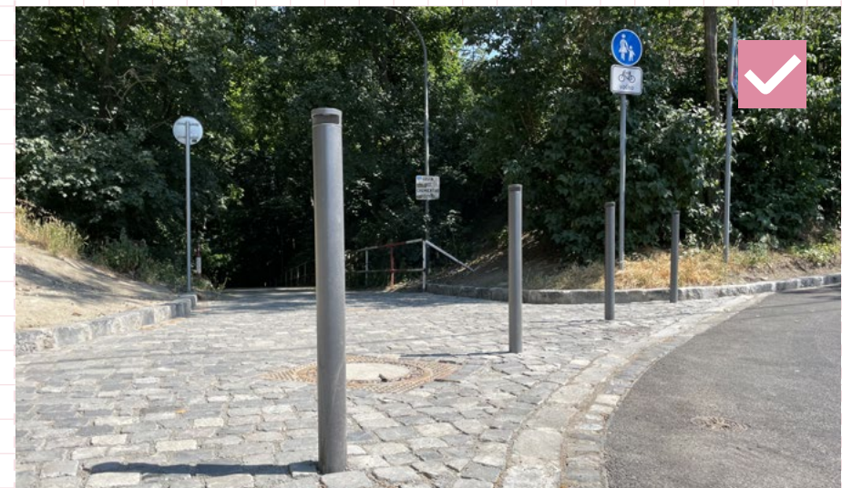
10 Príklad vhodného typu stĺpikov pre ostatné mesto – jednoduchý dizajn bez zbytočných detailov. Všetky stĺpiky by v rámci jedného priestoru mali byť vždy orientované tým istým smerom. Bratislava, Prokopa Veľkého
