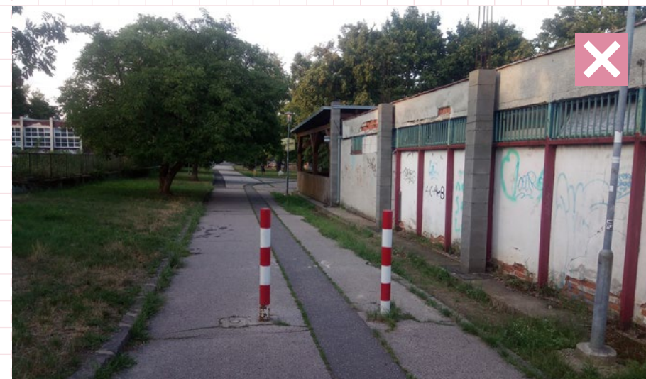
08 Príklad nevhodnej červeno-bielej farebnosti stĺpikov. V prípade nutnosti zvýraznenia stĺpikov z dôvodu zvýšenia bezpečnosti je vhodné na stĺpiky v antracitovej farbe umiestniť reflexné prvky v kontrastnej bielej farebnosti. Bratislava, Radlinského ulica
