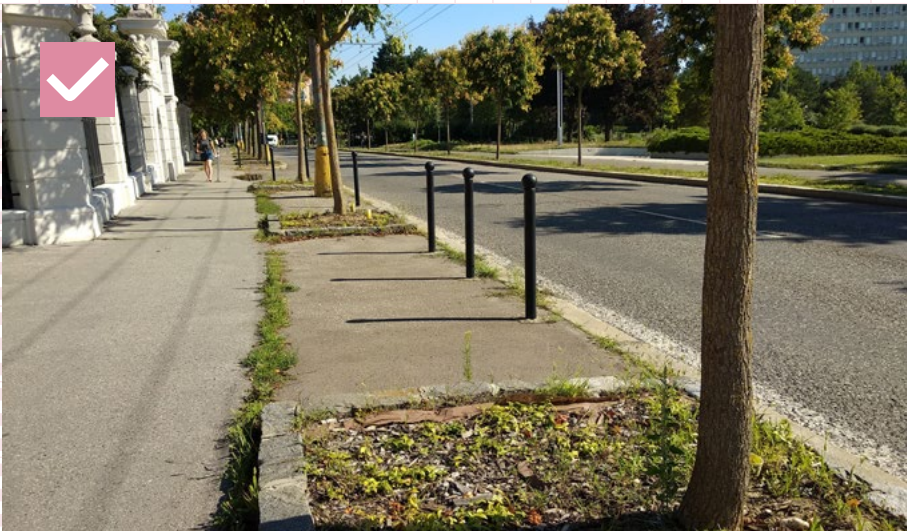
23 Príklad vhodnej praxe stĺpikov v prípade ulice so stromoradiím. Stĺpiky sú umiestnené osovo súmerne vzhľadom na priestor medzi stromami a je zachovaný rytmus – rovnaká vzájomná vzdialenosť medzi stĺpikmi. Bratislava, Námestie slobody
