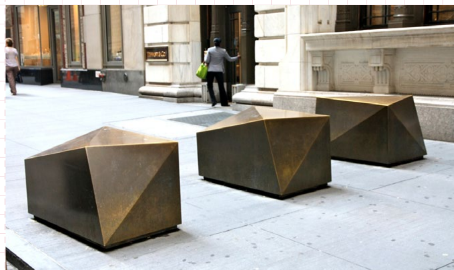
13 Jeden z príkladov možného poňatia fyzickej bariéry proti vjazdu automobilov ako formy originálneho dizajnerskeho počínu vo verejnom priestore. V tomto prípade ide o vhodnú kombináciu estetiky a funkčnosti. Originálny dizajn by mal vziť z návrhu architektov, dizajnérov, príp. príbuzných profesií a mal by zohľadňovať a podporovať kvality prostredia. Austrália
