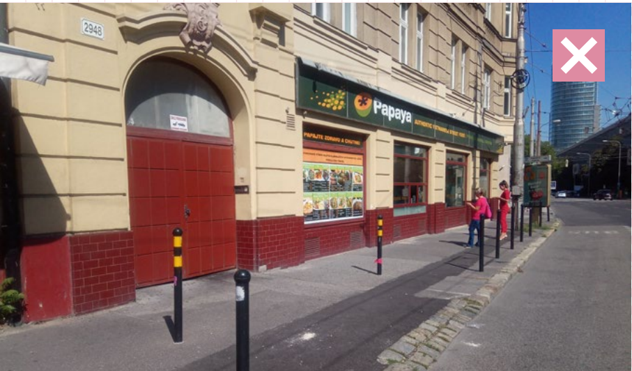
28 Príklad umiestňovania stĺpikov pri vjazde do garáže, pasáže alebo vnútrobloku. Umiestňovať jeden samostatný stĺpik uprostred chodníka sa neodporúča. Takto umiestnený stĺpik tvorí bariéru fyzickú aj vizuálnu. Bratislava, Námestie 1. mája
