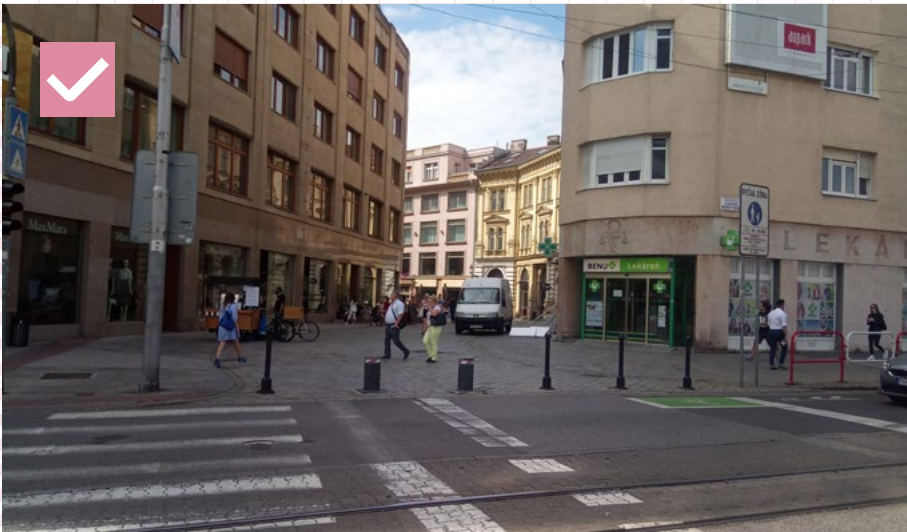
25 Príklad umiestňovania stĺpikov pri vjazde do pešej zóny. Stĺpiky by sa nemali používať výsuvné ako na obrázku, ale sklopné v rovnakom dizajne ako ostatné stĺpiky. Výsuvné stĺpiky by mali byť ideálne umiestnené v strede. Bratislava, Laurinská ulica
